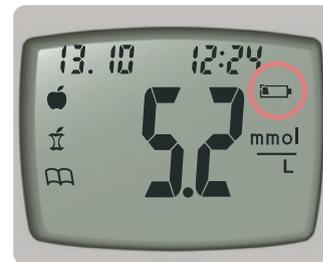
1. Prima di sostituire le batterie, spegnere lo strumento.
