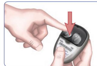
4. Posizionare le nuove batterie sotto le forcelle e nel compartimento della batteria, con il segno "+" rivolto verso l'alto.
