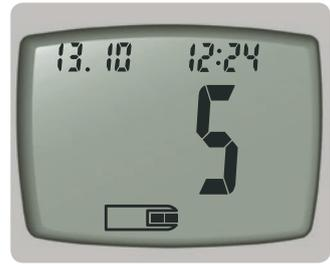
Lo strumento riconoscerà immediatamente il risultato del test di controllo e lo contrassegnerà automaticamente ✓.
