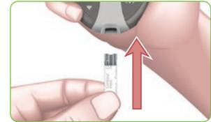
Lo strumento si accende. Sul display verrà visualizzata una striscia reattiva con una goccia di sangue lampeggiante per informare che lo strumento è pronto per eseguire il test.
