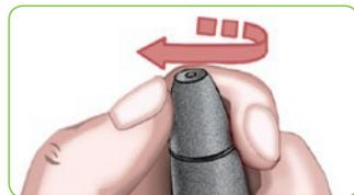
6. Ruotare il selettore del coprilancetta per scegliere la profondità della puntura. Anche la pressione applicata sulla zona influisce sulla profondità della puntura.
