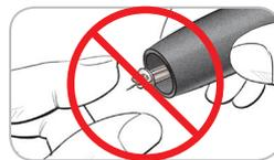
1. Non usare le dita per rimuovere la lancetta dal dispositivo di prelievo. Il dispositivo ha un meccanismo di espulsione automatica della lancetta.
