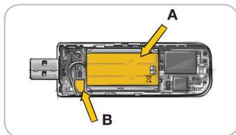
Forzare il caricatore della batteria da qui (A). Scollegare la batteria tirando il rispettivo connettore (B).
