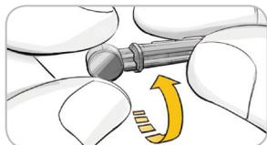
2. Allentare il cappuccio di protezione rotondo sulla lancetta ruotandolo di  $\frac{1}{4}$  di giro, ma senza rimuoverlo.
