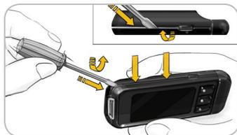
Per rimuovere la batteria al fine di consentirne un adeguato smaltimento, è necessario aprire la parte superiore e la parte inferiore esercitando una leggera pressione.
