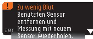
Wenn Sie nicht binnen 30 Sekunden genügend Blut an den Sensor führen, wird auf der Anzeige eine Nachricht erscheinen, die Sie auffordert, den Sensor zu entfernen und die Messung mit einem neuen Sensor zu wiederholen.
