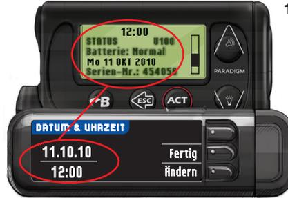
17. Datum und Uhrzeit auf Ihrem **Messgerät** müssen dem Datum und der Uhrzeit Ihres **Medtronic-Systems** entsprechen. Nehmen Sie das Medtronic-System. Drücken Sie **ACT** (Ausführen), um zum
