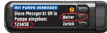
13. Wählen Sie auf Ihrem kompatiblen Medtronic System **Ser.-Nr. Übersicht**, um festzustellen, ob die Seriennummer Ihres CONTOUR®NEXT LINK Messgeräts korrekt eingegeben wurde. Kehren Sie bei einer fehlerhaften Eingabe zu Schritt 10 zurück.
